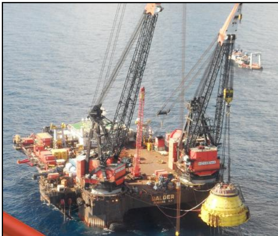
Figura 5. Buque típico de carga pesada con posicionamiento dinámico
