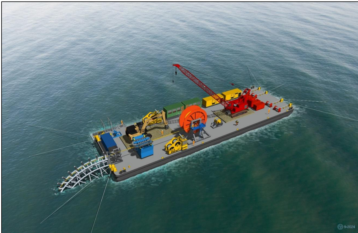
Figura 9. Esquema del buque de apoyo al de tendido de cables inverso
