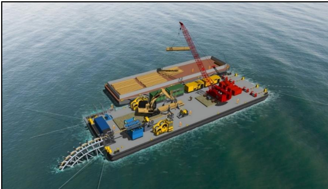
Figura 8. Esquema del buque de tendido inverso de tuberías y del buque de apoyo y el de materiales
